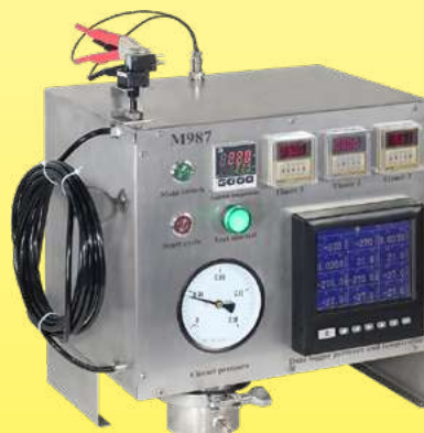
Equipo de ensayo para medir repetida y constantemente la longitud máxima de los tubos de conexión del pulsador de aire en función del volumen del pulsador y de la presión que desarrolla (Laboratorio Ultimheat)
