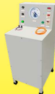
Verificación de los ciclos de funcionamiento de los interruptores de aire
